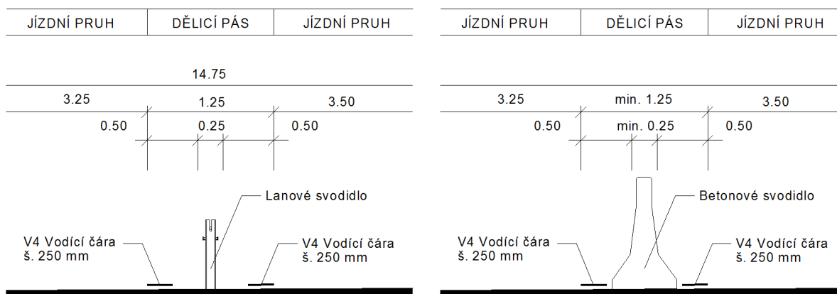
Obr. 11. Umístění svodidla v dělicím pásu
